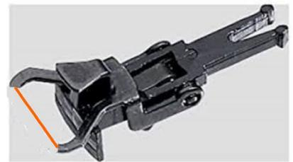
Der Ausschnitt wird durch einen 0,5mm Messingdraht ersetzt, (eingelötet von unten)
