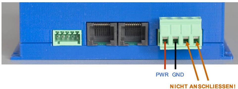
Fig. 12 : Raccordement de l'alimentation électrique au TM44
