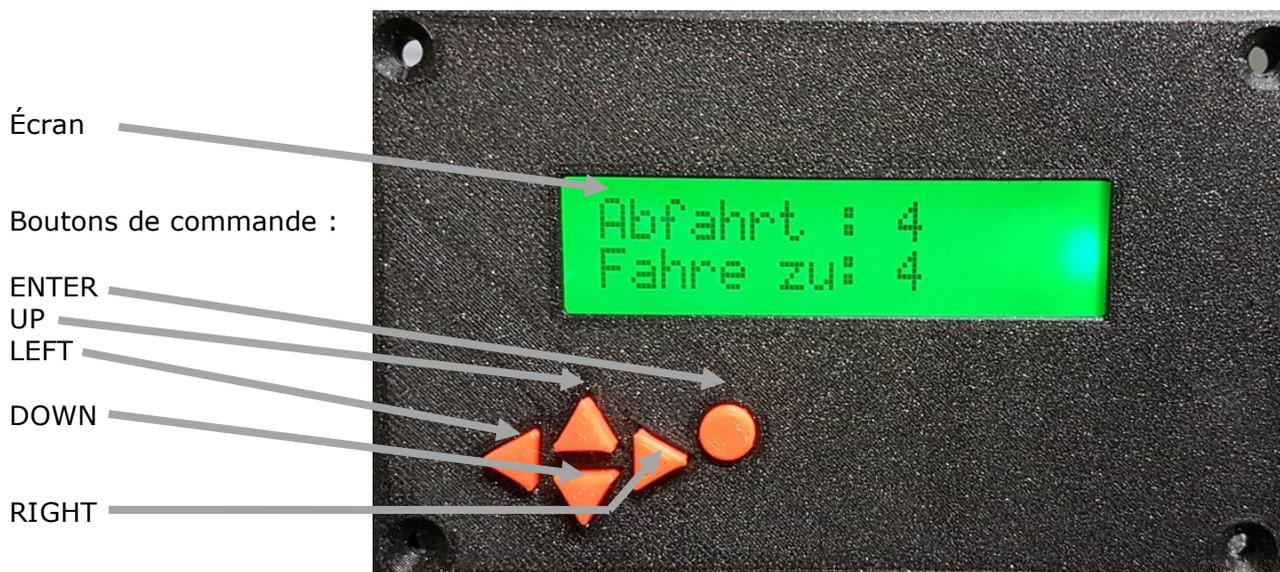
Contraste : Le contraste de l'écran peut être réglé à l'aide d'un tournevis (potentiomètre bleu au dos de la platine d'affichage). Il est également possible de le tourner de manière à ce qu'il ne soit plus visible.
