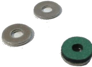
Pour l'insonorisation, collez les morceaux de caoutchouc mousse sur les rondelles et sur le moteur pas à pas.
