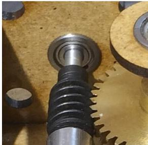
Vous pouvez maintenant placer l'arbre avec la roue à vis sans fin sur le moteur et le visser, il doit rester un espace d'environ 1 mm entre l'arbre et le moteur.
