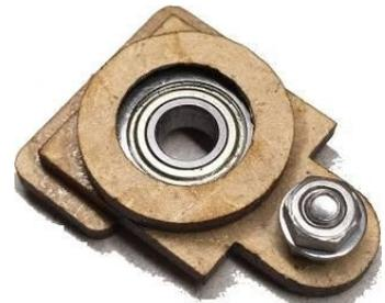
Vous pouvez maintenant insérer la vis à tête fraisée, celle-ci est fixée avec un écrou, puis une rondelle
