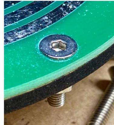
Le disque abrasif est vissé sur la pièce de fixation.
