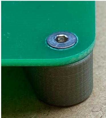
Les trous pour les vis à tête fraisée sont à réaliser soi-même ! Veillez toujours à tester l'engrenage au préalable.
