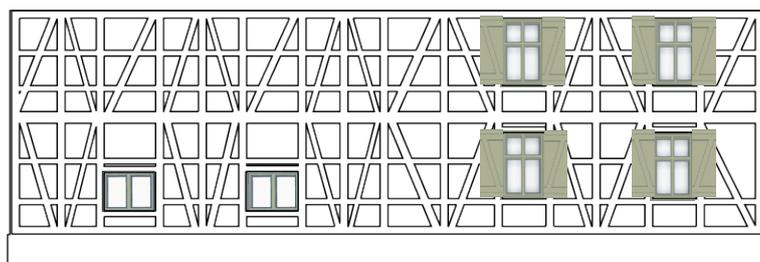
Pour assembler la maison, il faut coller les façades et les pignons. L'ajustement se fait en utilisant les pignons, les colombages permettent un alignement précis.
